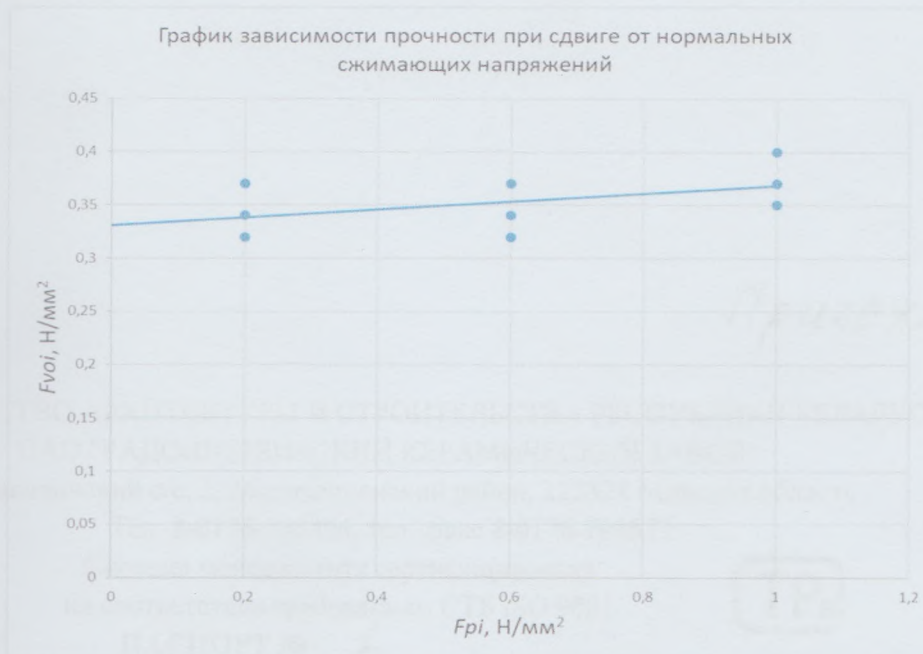
Рисунок 6 – график зависимости прочности при сдвиге от нормальных сжимающих напряжений
